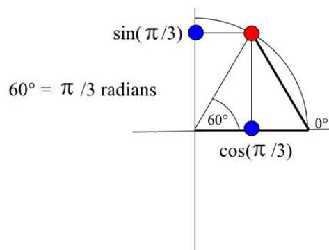
Fig. 2.5 – Coordonnées d'un sommet de l'hexagone
